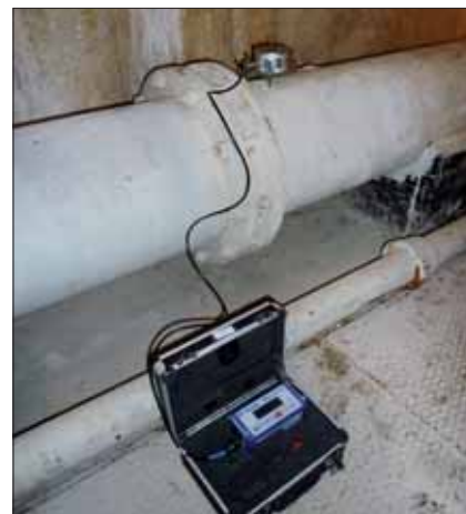
Úřední seismické měření při zkušebních odstřelech, jedno z měrných míst na litinovém potrubí spodní výpusti, detail osazení seismografu – triaxiální geofon chvění s orientací ve třech směrech kmitání x, y, z
