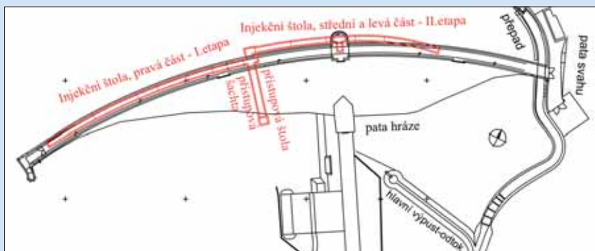
Schéma nové vybudovaných podzemních objektů na VD Janov
