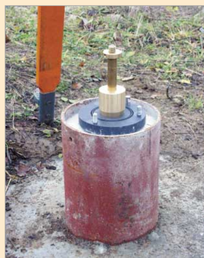
Obr. 7: Pohled na zhlaví vrtu, který je využíván jako vztažný bod pro geodetická měření, Rabenov 25. 11. 2002
