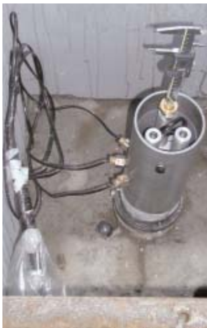
7. Pohled na zhlaví extenzometrického vrtu s úpravou pro dálkový i ruční odečet
