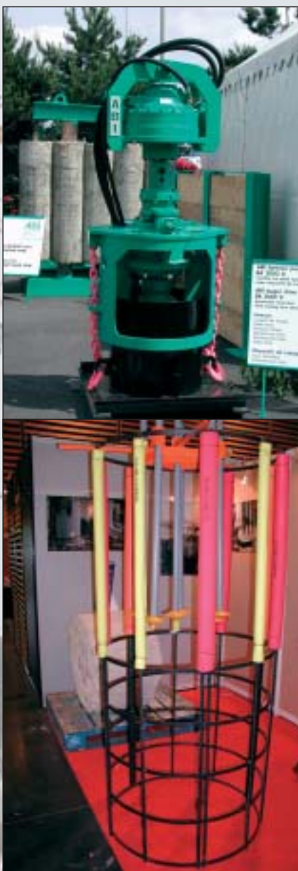
Polystyrenové návleky osazené na armatuře piloty definují oblast, která bude odstraněna ...
