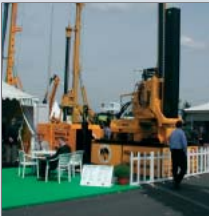
Hydraulické zatlačovací zařízení Still Worker firmy Tosa trading Co.
