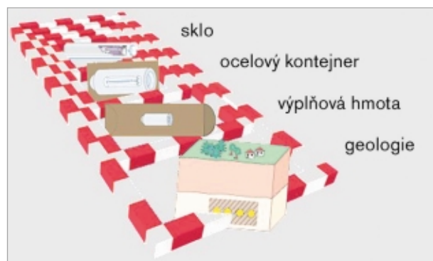
Obr. 2: Princip multibariérového systému
