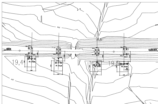
Pilotové založení železničního mostu, situace
