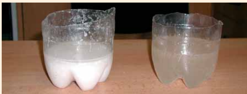
Vzorek čerstvě namíchané chemické injekční směsi (vpravo) a směsí, u které došlo po asi 1,5 hodině k jejímu zatuhnutí (vlevo)
