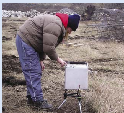
Obr. 3: Přesný gravimetr CG-3M (Scintrex, Kanada)
