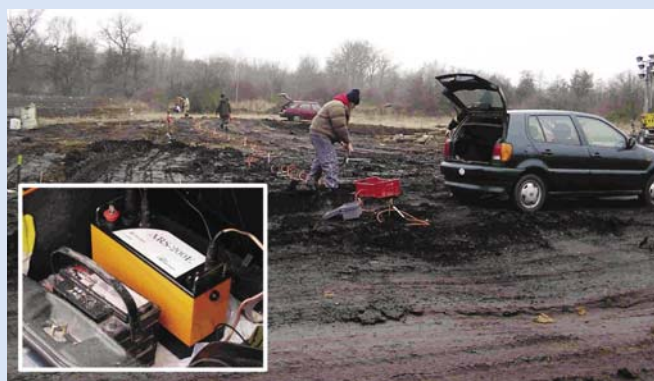
Obr. 2: Multielektrodová aparatura ARS-200E (GF Instruments, Brno) a příprava měření
