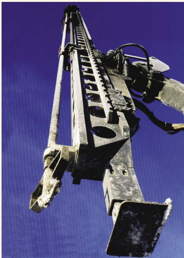
Vrtný nástroj s břitzy pro technologii hloubkového zlepšování zemin
