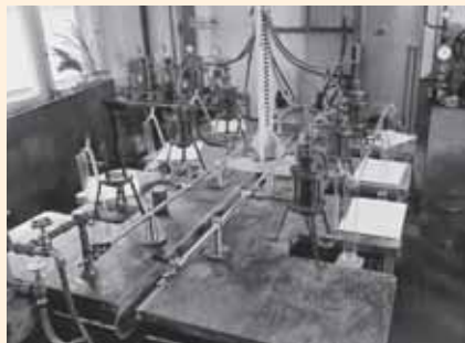
První československá laboratoř mechaniky zemin v Praze-Podbabě, propustoměry podle návrhu prof. A. Myslivece z roku 1932
