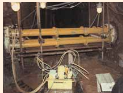
Výzkum stabilitních problémů lomů při úpatí Krušných hor, mohutná rozpěrná zkouška ve štolě Jezeří (1981)
