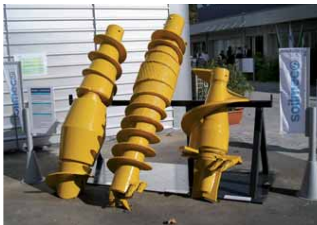
Omega piloty – vrtný nástroj
