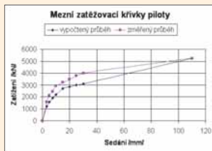
Obr. 3: Průběh mezních zatěžovacích křivek
