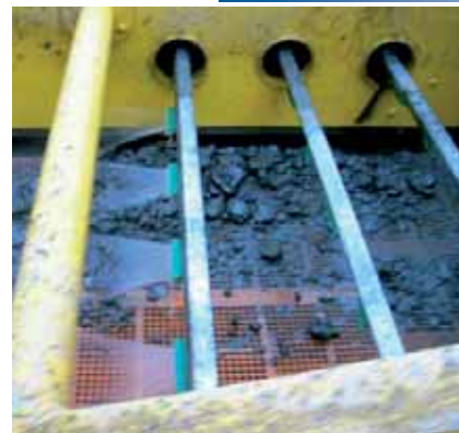
Obr. 8: Čištění kimberlitových vzorků
