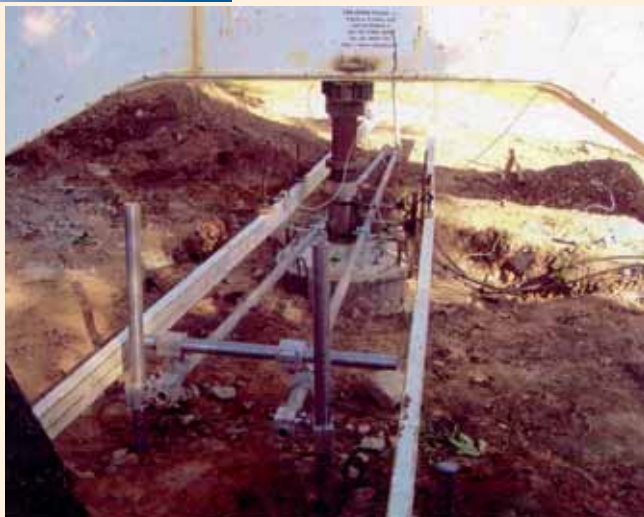
Obr. 1: Pohled na hlavu zkušební sloupy tryskové injektáže v průběhu statické zatěžovací zkoušky
