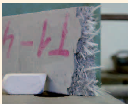
Obr. 8: Zkoušení cementových kompozitů vyztužených skelnými vlákny
