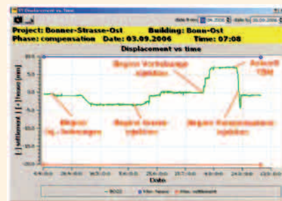
Obr. 11: Pohyby měřeného bodu od vrtní pro injektáž až po průchod štítu
