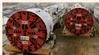
Obr. 4: Štítovací stroje o průměru 8,4 m na stavbě Jih
