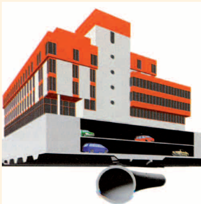
Obr. 12: Podejtí hotelu a podzemních garáží východním tunelem na úseku Sever
