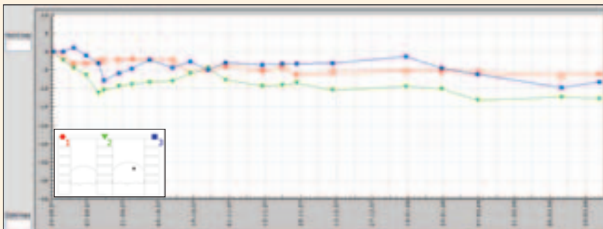
Obr. 3: Sedání bodů umístěných na hlavové převázcce pilotové stěny raženého portálu
