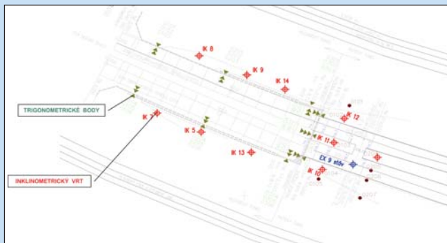
Obr. 11a: Schéma monitorovacích prvků jámy Komořany
