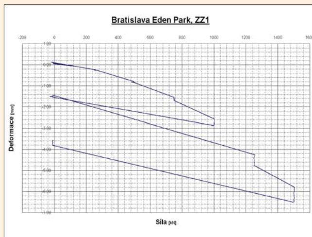
Obr. 2: Pracovní diagram zkušební pilíře TI ZZ1
