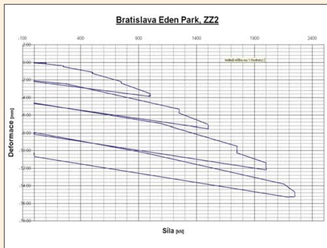
Obr. 3: Pracovní diagram zkušební pilíře TI ZZ2
