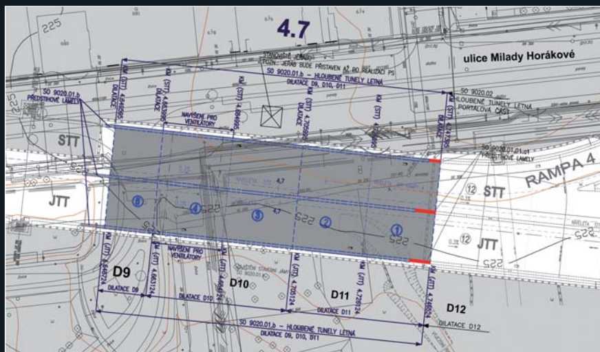
Půdorys stavební jámy pro výstavbu budoucích dilatací 9, 10, 11 tunelových tubusů v prostoru ulice Milady Horákové v Praze na Letné
