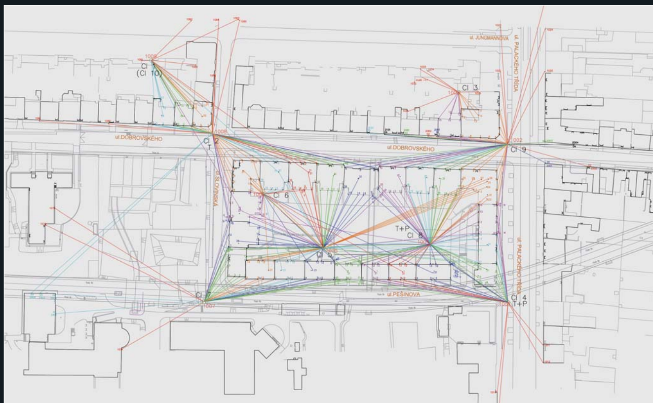
Obr. 3: Situace rozmístění totálních stanic s pokrytím měřených bodů
