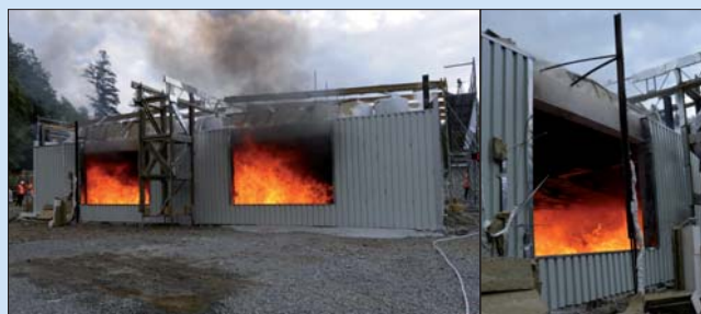
Pohled na objekt při zkoušce (vlevo) a sloup před oknem požárního úseku (vpravo)
