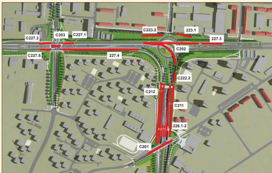
Předpolí žabovřeského portálu Královopolského tunelu s vyznačením založení mostních objektů, galerií, opěrných a zárubních zdí
