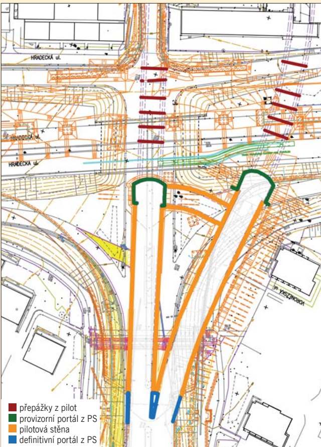
Hloubené úseky v oblasti žabovřeského předpolí Královopolského tunelu
