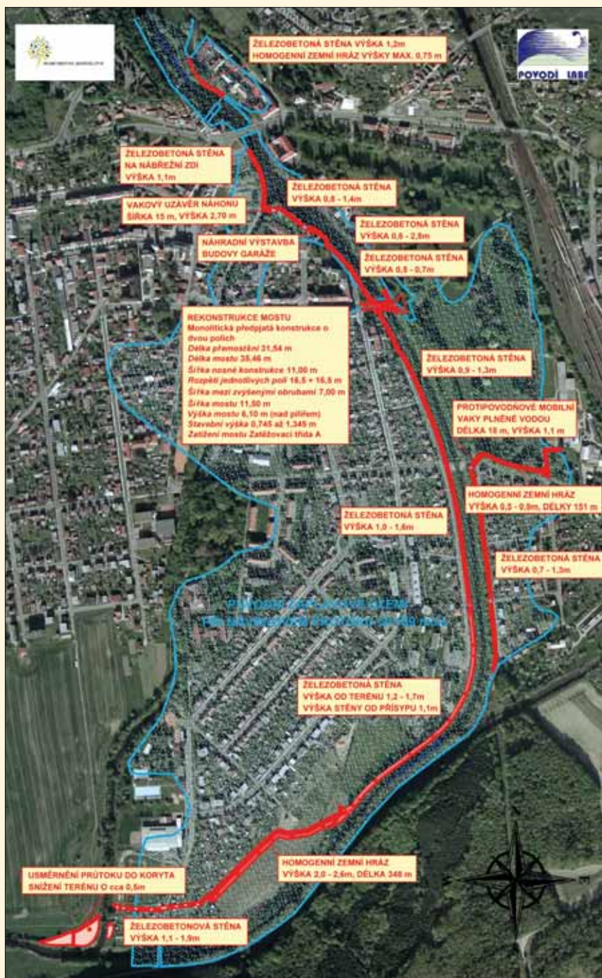
Situace protipovodňových opatření v Chocni
