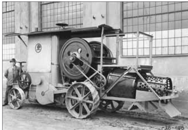
Drtič Škoda byl sice určen především pro silniční stavby, mohl však pracovat také přímo v lomu. Byl doplněn třídícím bubnem a vybaven vlastním pohonem prostřednictvím řetězového převodu.
