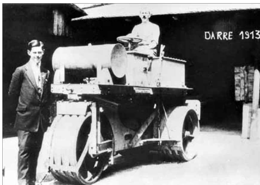
Při stavbách sypaných hrází v Hamrech a v Souši byl od konce prvního desetiletí 20. století používán válec francouzské firmy L. Brunet Fils, osazený dvouválcovým benzínovým motorem o 12 koních. Stroj s rýhovanými válci měl údajně hmotnost jen 3 tuny.
