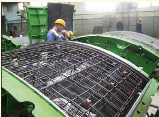
Obr. 11: Stacionární ocelové formy pro odlévání segmentů
