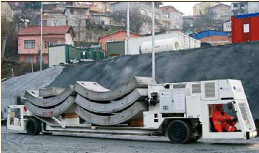
Obr. 8: Speciální víceúčelové vozidlo MSV bude díky schopnosti zdolat až 15% stoupání dopravovat tybinky mezi povrchem a podzemím.
