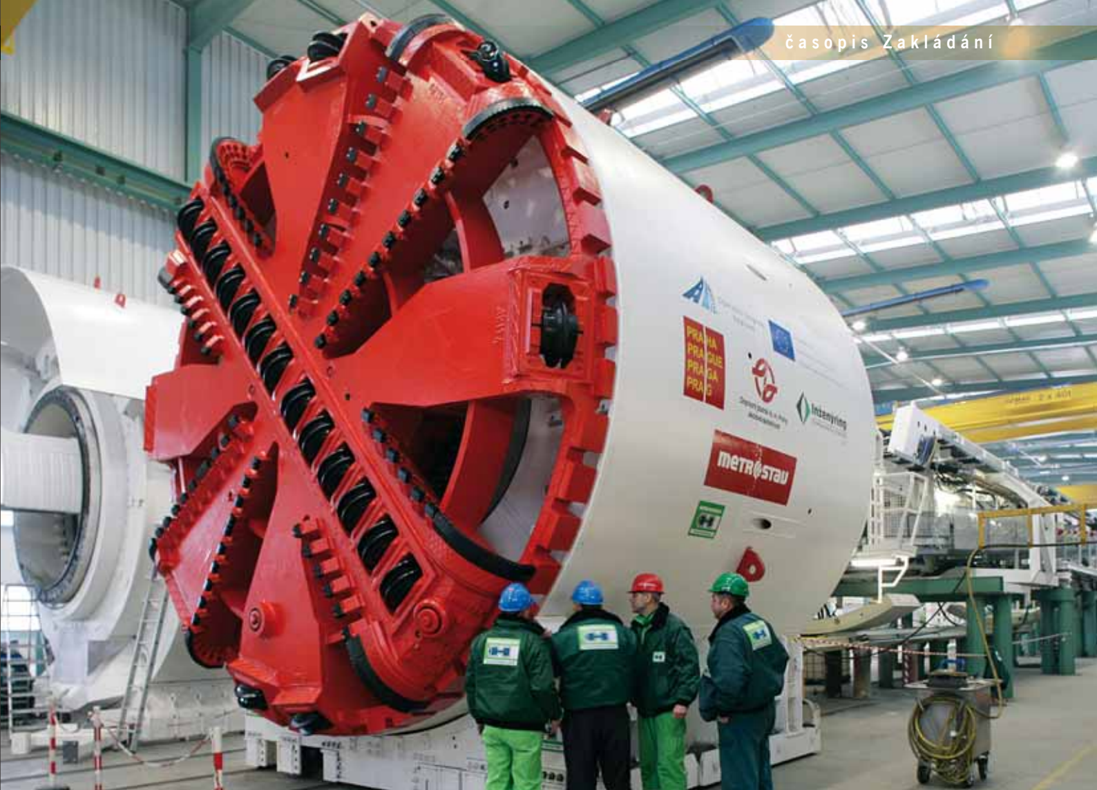
Obr. 1: Přebírka razicího stroje ve firmě Herrenknecht
