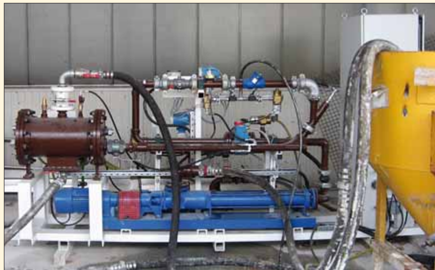
Obr. 10: Testovací zařízení firmy Herrenknecht určené pro simulování reálných podmínek směšování komponent A a B
