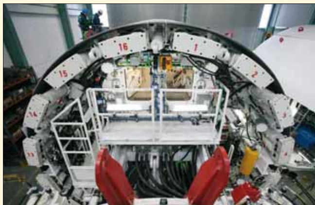
Obr. 4: Střední část štítu s rozpěrnými písky a lávkou na erektoru
