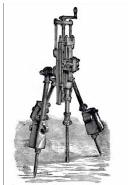
Obr. 4: Lehká pneumatická vrtačka podle patentu S. Ingersolla z roku 1871
