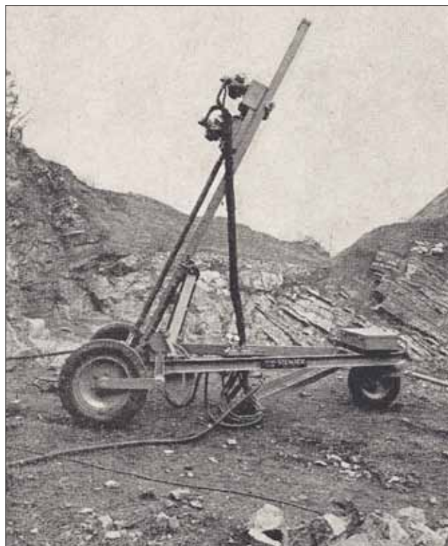
Obr. 7: Vrtná souprava firmy Stenuick, typu Record HS Universelle, na jejímž prototypu André Stenuick zkoušel nový způsob vrtání ponorným kladivem, rok 1950
