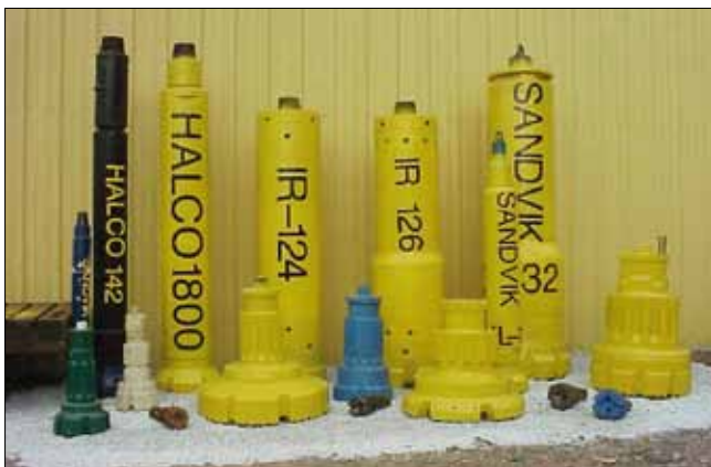
Obr. 8: Různé druhy ponorných kladiv a různých vrtných korunek na začátku 21. století
