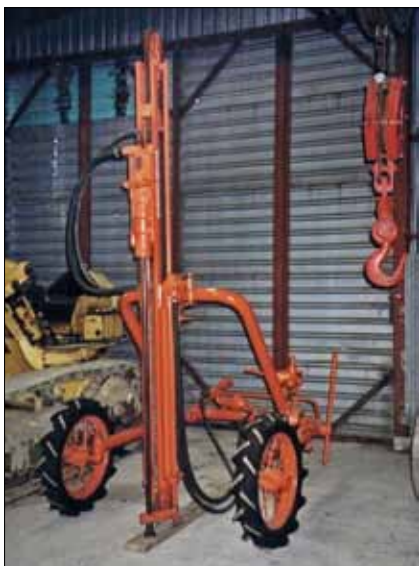
Obr. 5: Příklad velmi úspěšné lehké mobilní pneumatické soupravy typu Wagondrill pro vrtání s rotačním vrchním příklepem zejména v lomech, výrobek americké firmy Gardner-Denver z roku 1939
