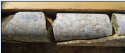
Charakteristická puklinatost žuly, vrt 11 N, 12–12,3 m
