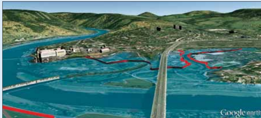
Znárodnění PP linie na pravém břehu Labe v Děčíně na úrovni Q_{100} + 30 cm a Q_{50} + 30 cm (více v textu). Za linií je orientačně znázorněno území, které by bylo zaplaveno při 50leté vodě.
