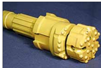
Obr. 5: Excentrická korunka ponorného kladiva systému ODEX firmy Atlas-Copco pro zavlékání pažnice v rozšířeném vrtu
