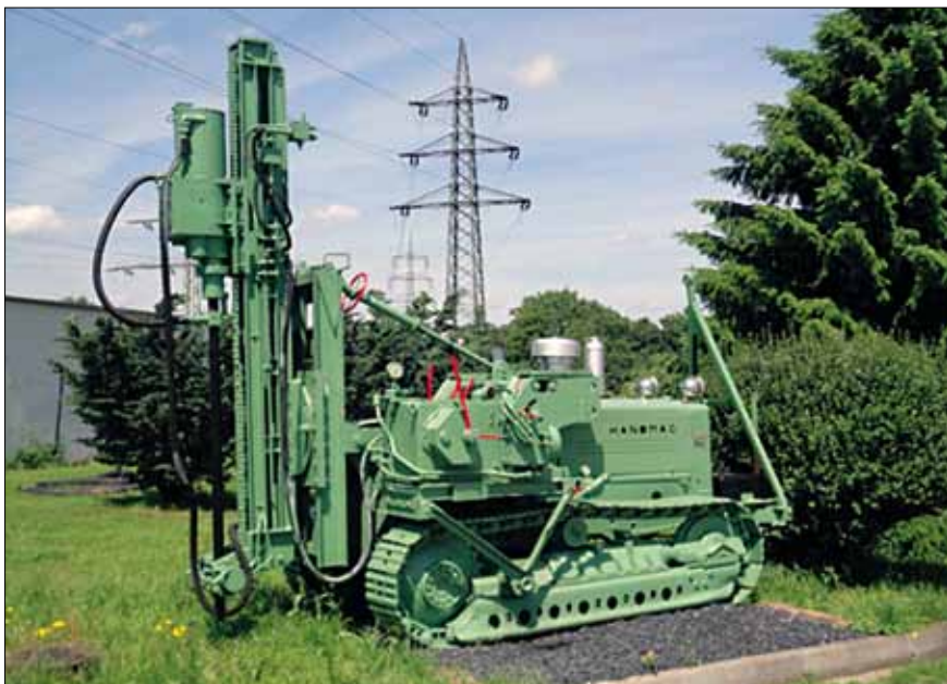
Obr. 11: První univerzální vrtná souprava E9 firmy Hausherr z roku 1959 s horní nasazenou hlavou
