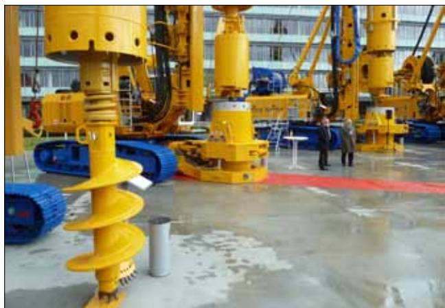
Vrtný šnek se sešikmeným spirálem pro jednodušší vyhazování vývrtku
