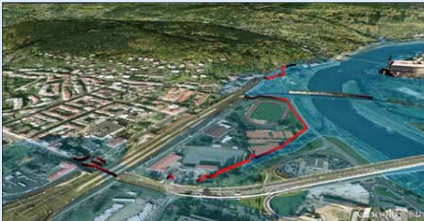
Znárodnění PP linie na levém břehu Labe v Děčíně na úrovni Q_{20} + 30 cm. Za linií je orientačně znázorněno území, které by bylo zaplaveno při 100leté vodě.
