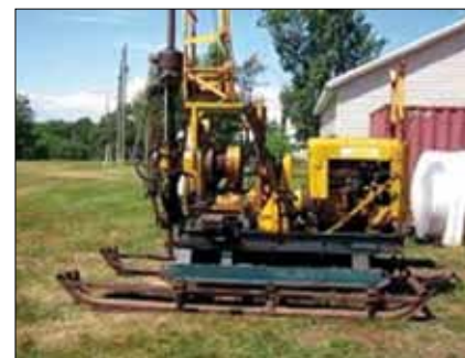
Obr. 3: Souprava Longyear 34 Coredrill – typický a populární zástupce jádrových vrtných souprav v druhé polovině 20. století. Přítlak i svěry vřetene jsou hydraulické.
