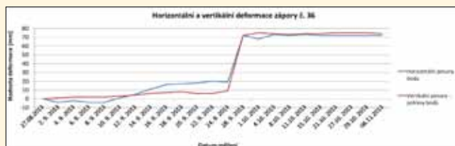
Obr. 3: Horizontální a vertikální deformace zápoře č. 36
