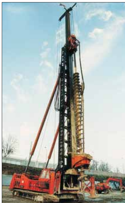
Obr. 7: Souprava pro vrtání pilot CFA typu Starsol – s teleskopickým vnitřním soutyčím, spodní vrtnou korunkou a s odstraňovačem odvrtné, Francie, rok 1978 (firma Soletanche)
