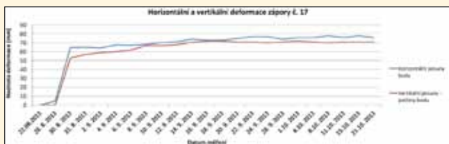
Obr. 2: Horizontální a vertikální deformace zápoře č. 17
