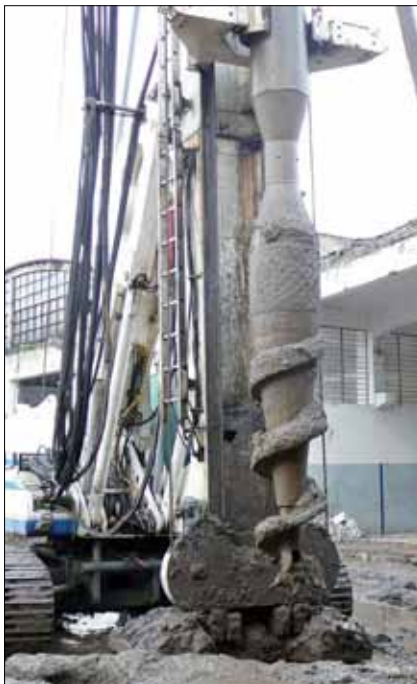
Obr. 9: Příklad vrtacího nástroje pro BDP se zřetelnou boční klapkou pro betonáž na špičce (firma Soilmec)
