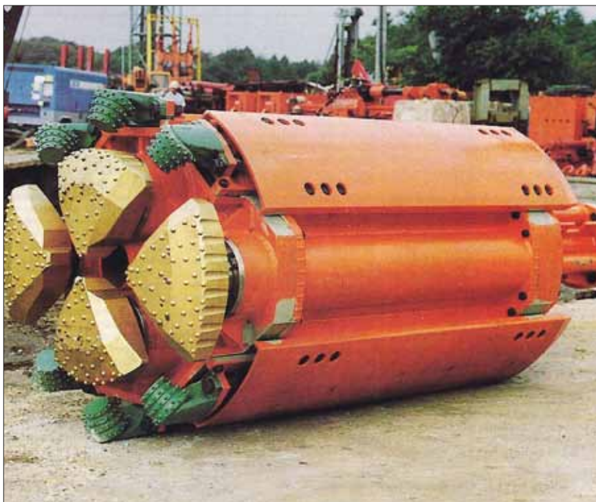
Obr. 13: Vrtný nástroj Mach R100 pro rotační vrtání sdužením čtyř vzduchových ponorných kladiv pro vrtání ve zvětralé žule s průměrem 1 m z roku 1988 (firma Tone Boring)
