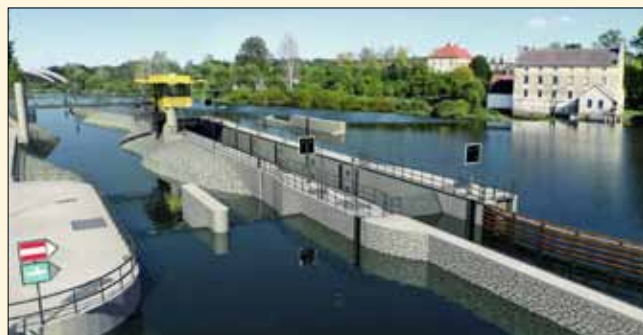
Vizualizace konečného provedení plavební komory s pohyblivým jezem a víceúčelovým koridorem u levého břehu
