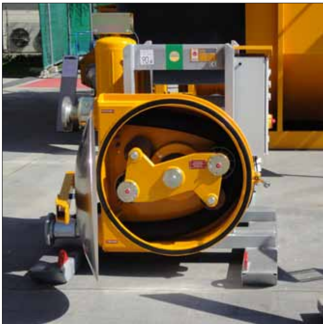
Obr. 6: Pohled do vnitřku hadicového čerpadla na husté stavební kaly se zřetelnými rotačními excentry tlačícími na hadici při vnitřním obvodu skříňě (BAUER Maschinen GmbH und MAT Mischanlagentechnik GmbH)
