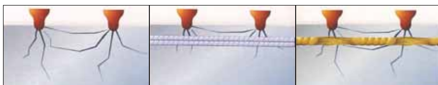
Rozvoj trhlin při tlaku valivých dlát na horninu nebo prostý beton na beton armovaný železnou výztuží a na beton armovaný sklolaminátovou výztuží
