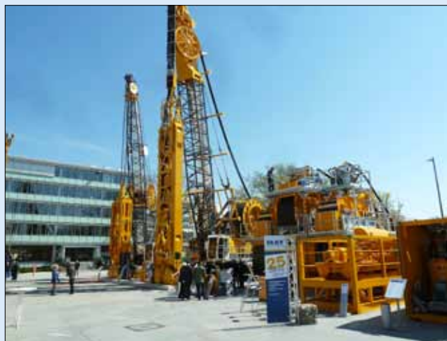
Kompletní vybavenost pro provádění podzemních stěn (zleva drapák, hydrofréza, čistička, dekanter, míchačka), chybí pouze zásobníky na pažící suspenzi
