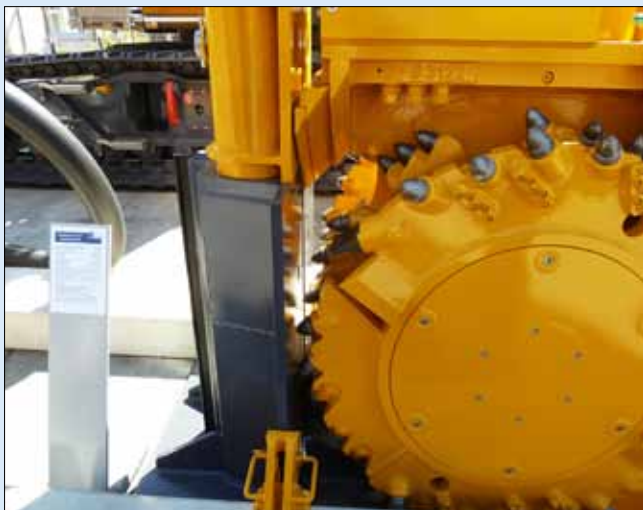
Detail nasazení hydrofrézy k stopendové pažnici
