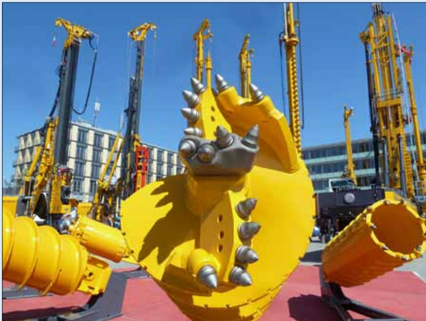
Z expozice velkopřůměrového vrtného nářadí f. BAUER Maschinen GmbH, v pozadí lafety vrtných souprav
