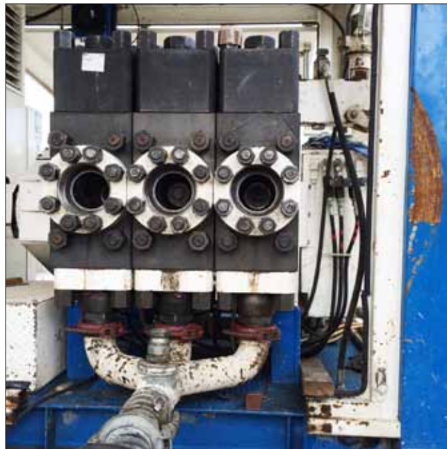
Obr. 7: Robustní trojitě tělo vysokotlakého čerpadla pro tryskovou injektáž s odkrytými hlavami plunžrů k maximálnímu pracovnímu tlaku až 90 MPa a se silným přívodem injekční směsi k maximálnímu dodávanému množství až 600 l/min (firma Soilmecc, počátek 21. století)
