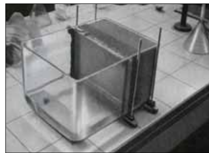
Obr. 3: Jeden z prvních pokusů Christiana Vedera z počátku 40. let, dokumentující, jak bentonitový filtrační koláč udrží i po odstranění suspenze svislou stěnu písku v rovnováze. Je vidět i dosah vody odfiltrované ze suspenze do písku (I.C.O.S.).
