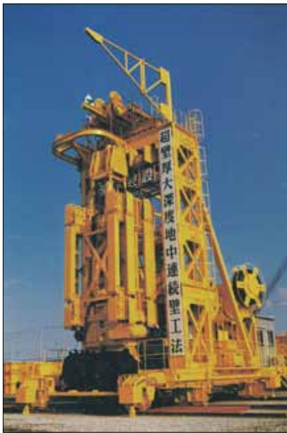
Obr. 12: Japonská fréza firmy Tone Boring typu EM 320 na elektrický pohon navržená na začátku 90. let pro základové elementy o rozměrech 3,2 x 3,2 m do hloubky až 150 m (Tone Boring Co.)
