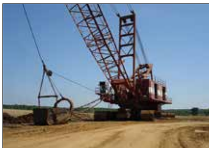
Obr. 1: Typický bagr s vlečným korečkem na konci 70. let v USA. Nosič firmy Manitowoc, model 6400, tah na laně 38 t, výložník 53 m s korečkem firmy Hendrix o objemu 10,5 m 3 (internet)
