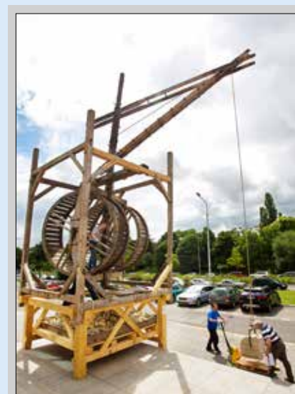
Replika středověkého stavebního jeřábu
