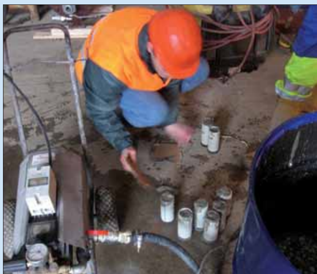
Odběr vzorků DKV na zkoušky pevnosti při poloprovozním pokusu
