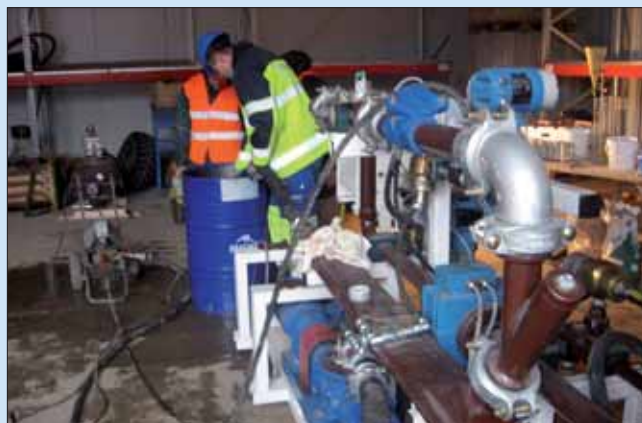
Obr. 2: Testovací zařízení Herrenknecht – výroba a odběr vzorků výsledné DKV
