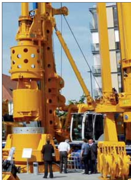
BG 30 „Premium Line“ – vlevo Kelly vrtání, vpravo CSM
