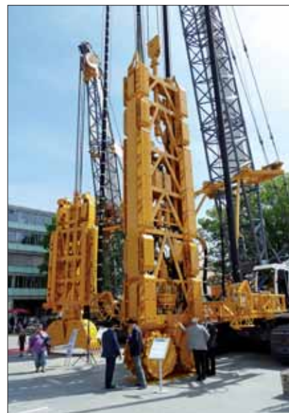
MC 96 s hydrofrézou BC 40
