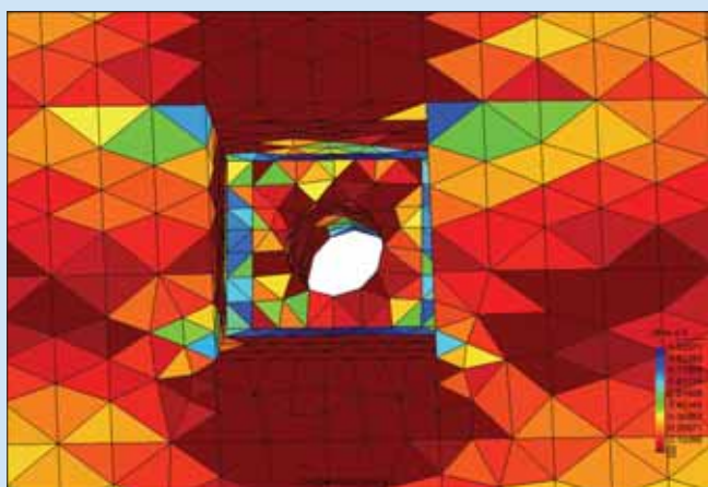
Obr. 5: Detail parametru poškození ve výklenku pod kotevním plechem. Pohled do výklenku – modrá barva znázorňuje parametr poškození blízký se hodnotě 1,0 (šířka trhliny 2 \cdot 10^{-5} m), odstíny červené barvy vyznačují oblasti nepoškozené.
