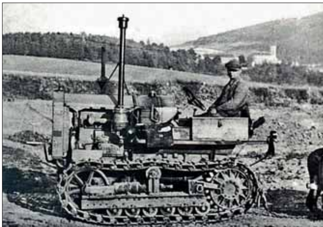
Traktor Hanomag, pózující před pozadím moravské Černé hory, používala firma Hrabě-Lozovský při budování německé dálnice severně od Brna.
