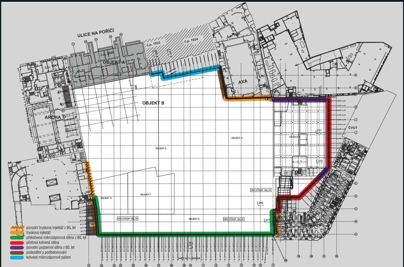
Půdorys stavební jámy jámy s vyznačením jednotlivých technologií pažení; v celém půdorysu byly dále zhotoveny základové piloty (v rastru převážně 8,1x8,1 m nebo 8,1 x 4,05 m)
