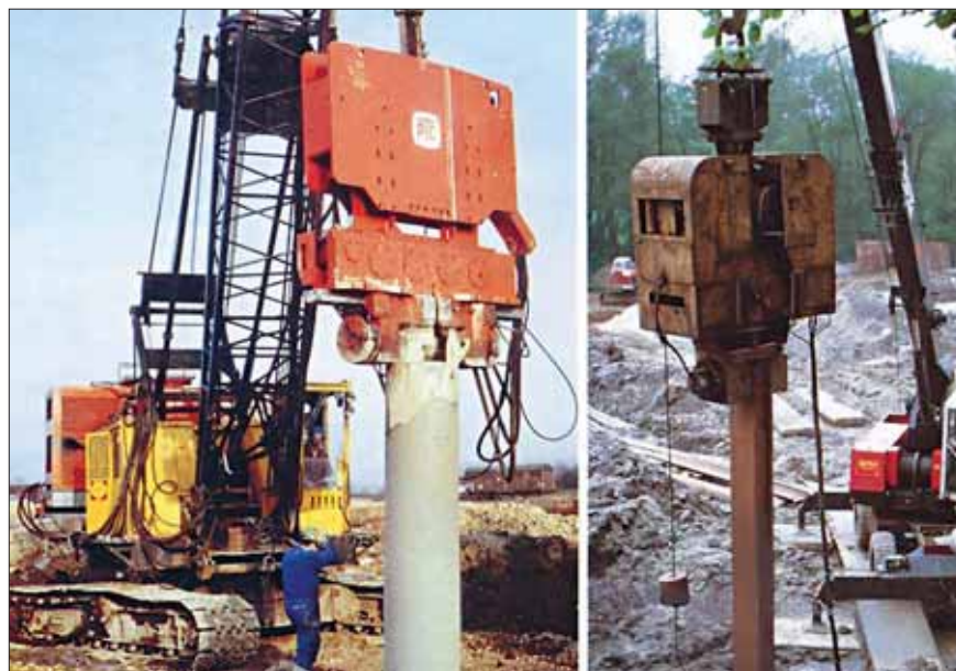
Obr. 5: Starší elektrický vibrátor z počátku sedmdesátých let minulého století (vpravo) a novější hydraulický vibrátor z počátku osmdesátých let (vlevo), výrobky francouzské firmy PTC
