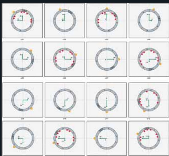
Obr. 1: Příklad rozmístění konvergenčních bodů podle typu segmentu (Technologický postup Metrostav, a. s.)
