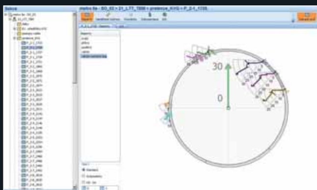
Obr. 3: Příklad deformací segmentového ostění u propojky 2.1, LTT, prstenec 1725 – vektorové zobrazení (sdružení ARCADIS – INSET)
