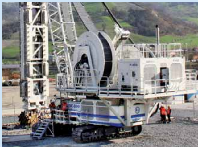
Obr. 7: Nová hydrofréza Tiger SC-200 firmy Soilmec
