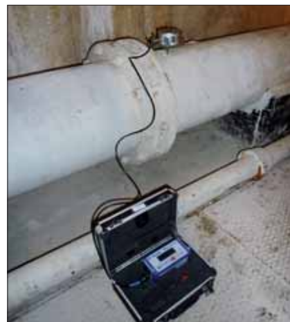
Úřední seismické měření při zkušebních odstřelech, jedno z měrných míst na litinovém potrubí spodní výpusti, detail osazení seismografu – triaxiální geofon chvěvní s orientací ve třech směrech kmitání x, y, z
