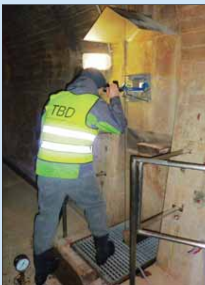
Měření náklonů hráze pomocí hrázového kyvadla
