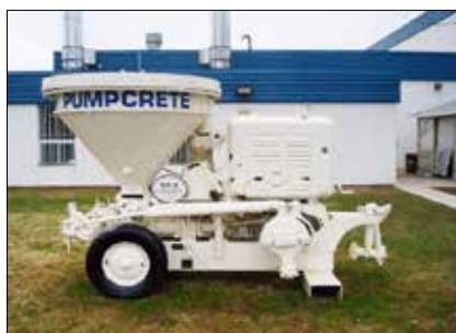
Obr. 5: Světově první průmyslově rozšířené čerpadlo cementové malty Rex Pumpcrete z konce 30. let v USA, po restaurování (RexCon)
