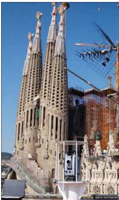
Obr. 11: Optický systém monitoringu pohybu konstrukcí při kompenzační injektáži pomocí automatických teodolitů na stavbě metra v blízkosti katedrály Sagrada Familia v Barceloně v roce 2003 (Soldata)
