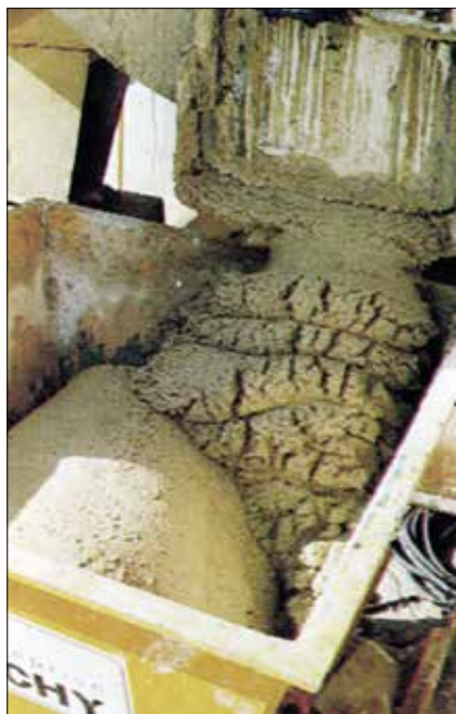
Obr. 3: Hustá cementová injekční směs používaná pro zhutňovací injektáž od roku 1985 v Evropě (Bachy)
