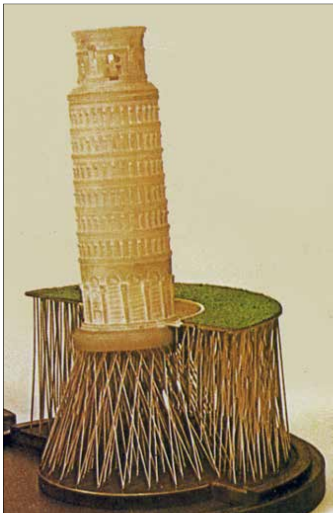
Obr. 3: Model řešení konsolidace náklonu šikmé věže v Pise pomocí hustého roštu z mikropilot podle teorie Dr. F. Lizzigo z 80. let 20. století (Fondedile)
