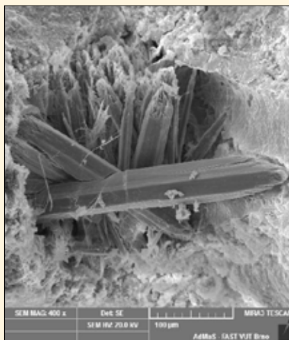
Obr. 16: Vlevo zvětšenina z protokolu VUT v Brně; (vzorek č. 5) – ettringit, vpravo zvětšenina z protokolu VUT v Brně; (vzorek č. 5) – thaumasit (oba vzorky odebrány z části pilíře pod hladinou kryté žulovým obkladem)
