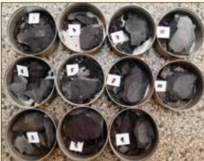
Obr. 7: Vzorky břidlice po zkoušce pevnosti v drcení
