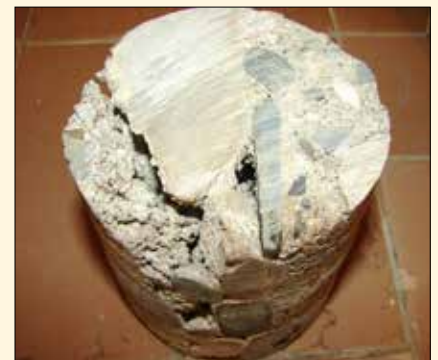
Obr. 10: Vlevo jádrový vývrt č. 4 dl. 2,9 m, pevnost betonu tohoto vzorku je v průměru 28,9 MPa, vpravo jádrový vývrt č. 6 (beton je ještě vlhký; 15 hod. po odběru) dl. 2,05 m. Pevnost betonu tohoto vzorku je v průměru 14,0 MPa.
