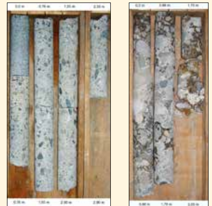
Obr. 10: Vlevo jádrový vývrt č. 4 dl. 2,9 m, pevnost betonu tohoto vzorku je v průměru 28,9 MPa, vpravo jádrový vývrt č. 6 (beton je ještě vlhký; 15 hod. po odběru) dl. 2,05 m. Pevnost betonu tohoto vzorku je v průměru 14,0 MPa.
