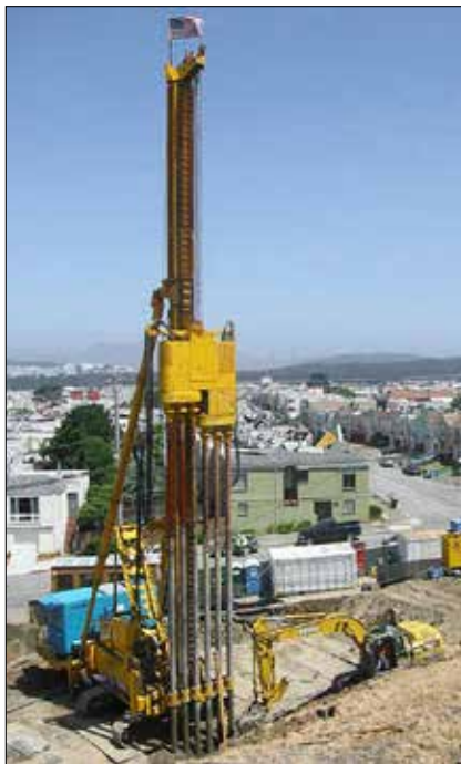
Obr. 7: Šestidřívková vrtací a míchací baterie soupravy pro soil-mixing americké pobočky firmy Raito Kogyo na konci první dekády 21. století (Raito Kogyo Co. Inc.)
