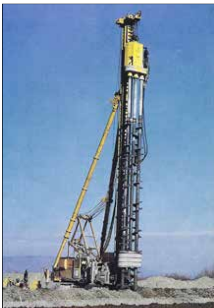
Obr. 3: Dlouholetou praxí osvědčený typ soupravy s trojitým vrtákem o průměru 86 cm a dosahem do hloubky 20 m pro metodu SWM japonské firmy Seiko na počátku 80. let (Seiko)
