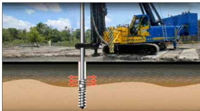
Roztlačování zeminy při zavrtávání/vytahování náradí
