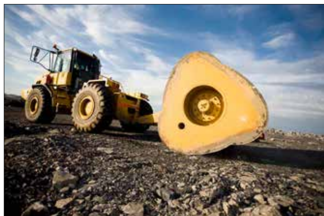
Obr. 3: Zařízení pro rotační nárazové hutnění zemin s trojbokým odvalovacím mechanismem jihoafrické firmy Landpac z období roku 2010 (Landpac)
