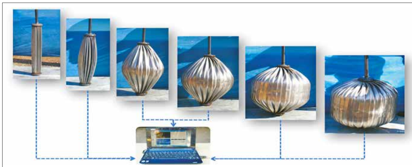
Princip roztažení těla EB piloty při injektáži se záznamem
