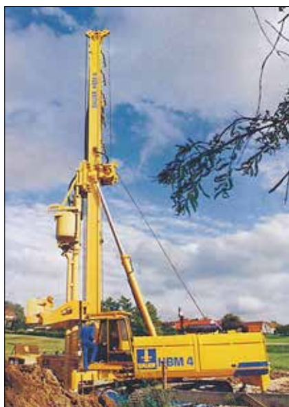
Obr. 11: Strojní plně hydraulická souprava HBM 4 firmy Bauer z roku 1988 pro provádění štěrkových pilířů do hloubky až 12 m (Bauer)
