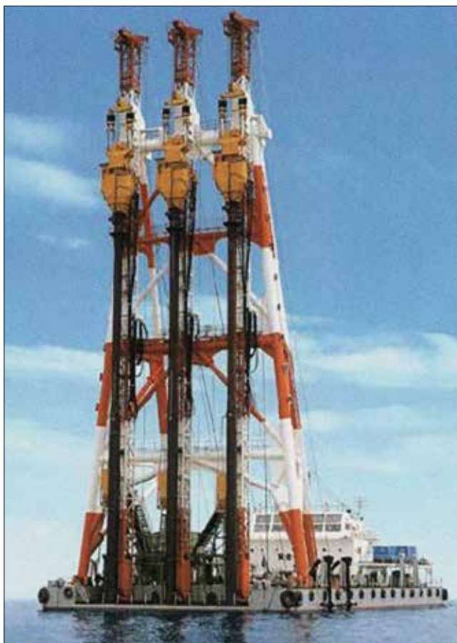
Obr. 7: Jihokorejská těžká námořní plně automatizovaná souprava ESC-50 k provádění pískových zhutňovacích pilot s třemi výpažnicovými jednotkami o průměru 80 cm a s dosahem do hloubky 50 m pod hladinu, z roku 2010 (Eunsung C&O)
