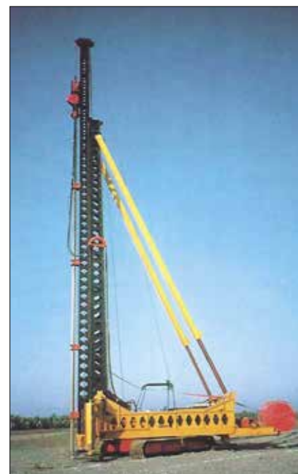
Obr. 3: Těžká vibrační souprava Fundex F30 pro instalaci geodrenů do hloubek desítek metrů v 90. letech 20. stol. (Soletanche)
