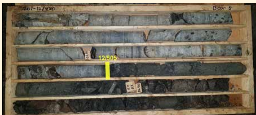
Obr. 10: Jádrový výnos z vrtu po jezerem Mälaren ve staničení 12/505 m
