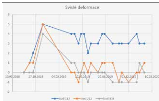
Obr. 5: Časový průběh svislých deformací bodů na objektu Nadace ABF (+ zdvih, – pokles)
