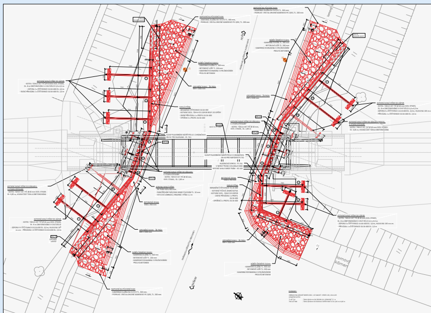
Železniční most v Lužci, úprava břehu kanálu, trvalé štětové stěny jsou kotveny pomocí táhel do opěr a ke kotevním štětovicím
