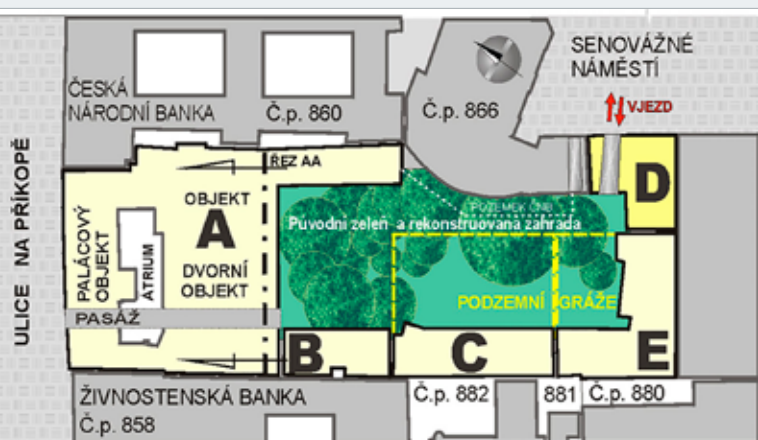
Situace stavby s vyznačením hlavních objektů
