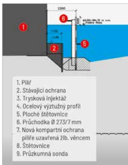
Fáze 1 opravy pilíře č. 8
